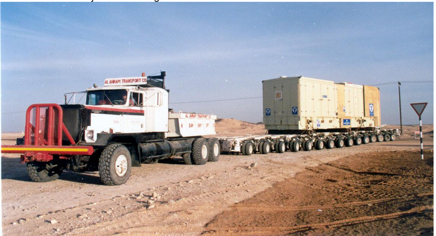
De gasturbine in de omkasting op transport met zo'n 5 km/uur door de woestijn van Oman. Al Ahram was een onderdeel van het Nederlandse Jumbo.
